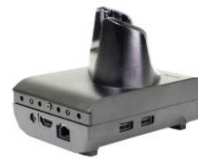
Workstation Cradle mit HDMI, 4 x USB und Ethernet Anschluß.
